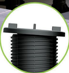
La TÊTE AUTONIVELLANTE, disponible en version plate, avec des ailettes de garniture prédécoupées de 2,3,4,6,8,10 mm d'épaisseur et Ø 130 mm, a l'avantage, en présence de pentes, de pouvoir poser la base sur place directement sur la surface inclinée sans utiliser de composants supplémentaires. Cette caractéristique nous permet de niveler automatiquement des pentes jusqu'à un maximum de 9% environ.
