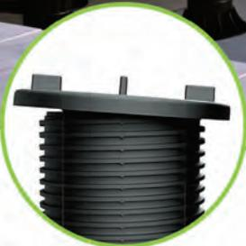
La TÊTE AUTONIVELLANTE, disponible en version plate, avec des ailettes de garniture prédécoupées de 2,3,4,6,8,10 mm d'épaisseur et Ø 130 mm, a l'avantage, en présence de pentes, de pouvoir poser la base sur place directement sur la surface inclinée sans utiliser de composants supplémentaires. Cette caractéristique nous permet de niveler automatiquement des pentes jusqu'à un maximum de 9% environ.
