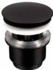
Bonde clic-clac 1"1/4x D63mm Clapet D66mm (adaptable en écoulement libre), laiton.
