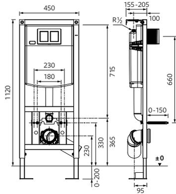
**FIXATION MURALES INCLUSES** permettant un ajustement en profondeur et en angle
