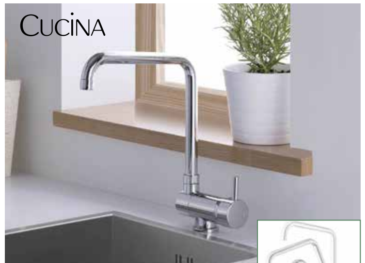
Mitigeur évier avec bec basculant sous fenêtre Le mitigeur de cuisine Cucina a été conçu pour répondre à la problématique d'un évier juste en dessous d'une fenêtre. Une fois installé, si vous avez besoin d'ouvrir votre fenêtre, il vous suffira de faire basculer le bec du robinet. Passage sous fenêtre 7 cm. Bec orientable. Hauteur 340 mm.
