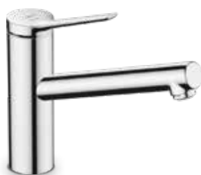
Mitigeur évier 150 CoolStart : démarrage en eau froide en position de poignée centrée, bec orientable possible sur 2 niveaux 60° ou 110°, jet Normal, débit maximal à 3 bars: 7,6 l/min, limiteur de température réglable, flexibles de raccordement, set de fixation.
