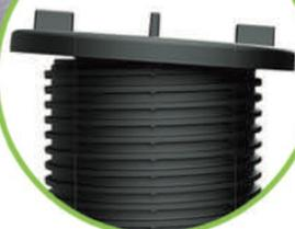
La TÊTE AUTONIVELLANTE, disponible en version plate, avec des ailettes de garniture prédécoupées de 2,3,4,6,8,10 mm d'épaisseur et Ø 130 mm, a l'avantage, en présence de pentes, de pouvoir poser la base sur place directement sur la surface inclinée sans utiliser de composants supplémentaires. Cette caractéristique nous permet de niveler automatiquement des pentes jusqu'à un maximum de 9% environ.
