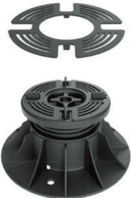
Les silencieux pour têtes réalisés en caoutchouc insonorisant et antidérapant sont conçus pour réduire le bruit résultant du piétinement sur les planchers surélevés et servent également d'antidérapant sur le revêtement de sol installé. Ils sont installés directement sur la partie supérieure de la tête et ne nécessitent pas d'être fixés.
